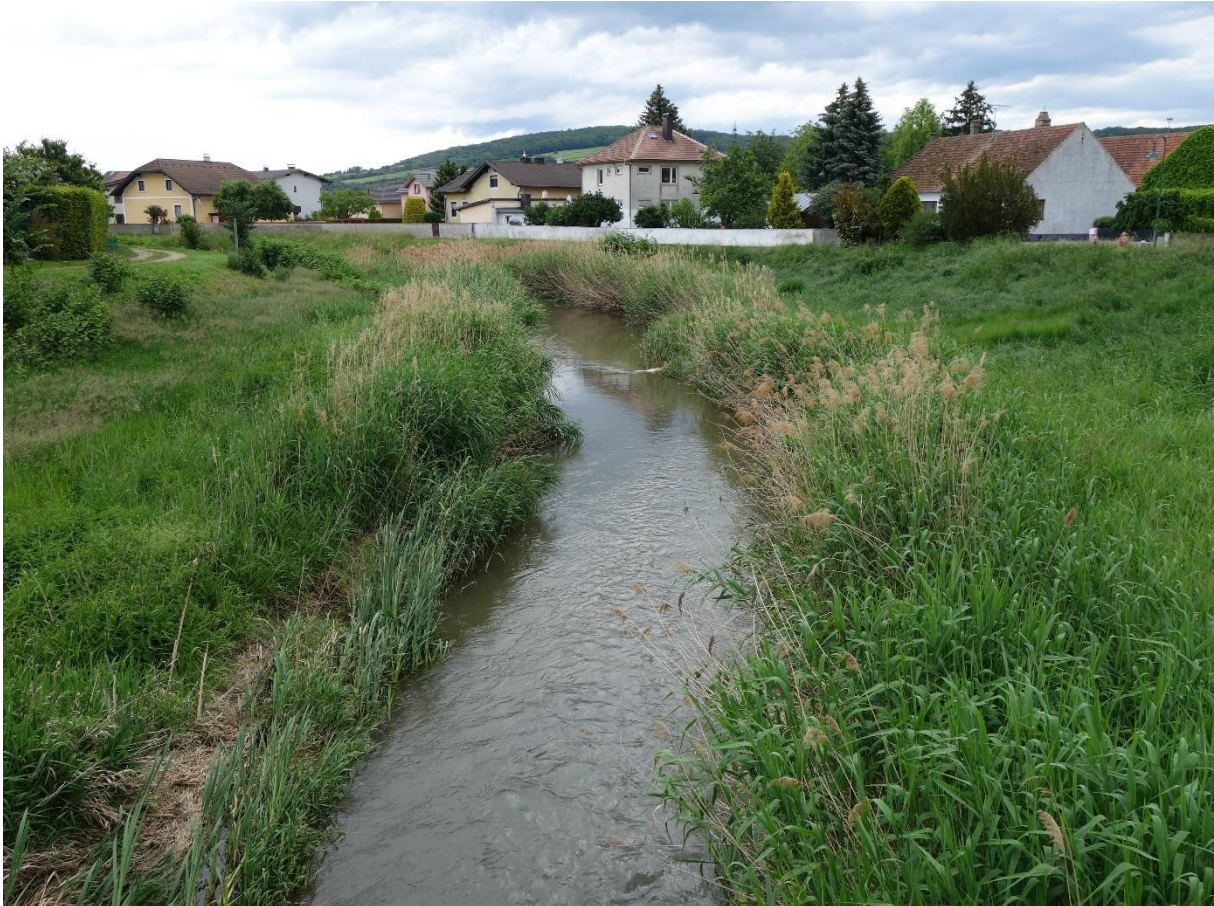
Abbildung 21: Begradigter Lauf der Großen Tulln in Judenau (Foto: BPWW/J. Scheiblhofer)
